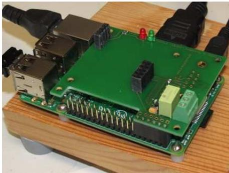
Für den Anschluss unserer Platine verwenden wir nur die Pins 2, 4, 6, 8, 10 und 12 vom GPIO-Stecker des Raspberry Pi. Alle anderen Pins stehen weiterhin für ihre anderen Anwendungen zur Verfügung.
